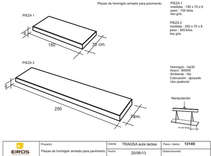
El espesor de la pieza viene dado por la dimensión de la misma, considerando que a mayor dimensión de la pieza mas espesor ha de tener, lo más habitual es producir en espesores de 6 , 8 y 10 cm.
