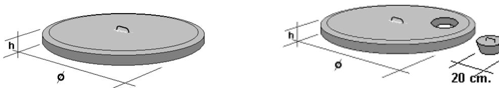
Tapa de pozo de hormigón armado sin registro
